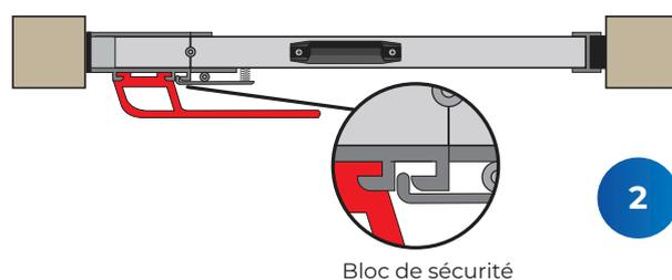
Il suffit d'insérer la poignée de compression rouge en aluminium dans la glissière et pousser en avant. Ce geste permet d'étendre la barrière horizontalement en exerçant une force de compression sur les joints latéraux.
