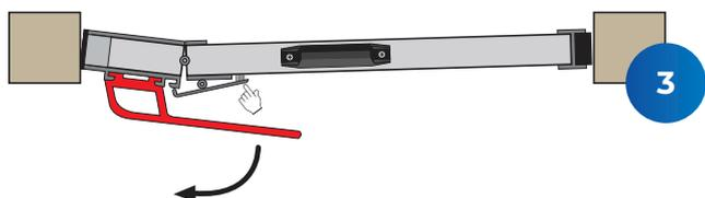
Pour désinstaller le bloc il suffit de presser sur le bloc de sécurité pour pouvoir décompresser le batardeau.
